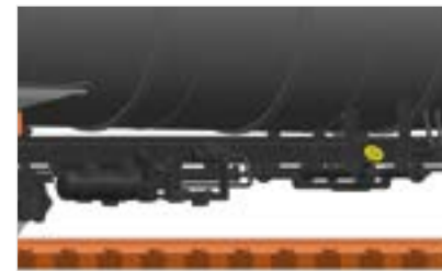
Separat angesetzte Teile und Leitungen an der Kesselunterseite
