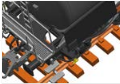
Rangierbühne und Laufgitter durchbrochen dargestellt
