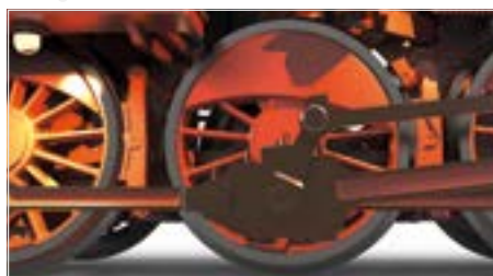
Teilweise durchbrochen dargestellter Barrenrahmen
